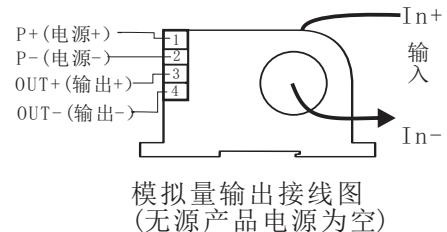
模拟量输出接线图
