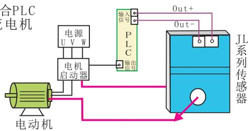
示例四：结合接触器间接接控制交直流负载(比如：继电器，交流接触器，PLC模块，蜂鸣器，光源等)
